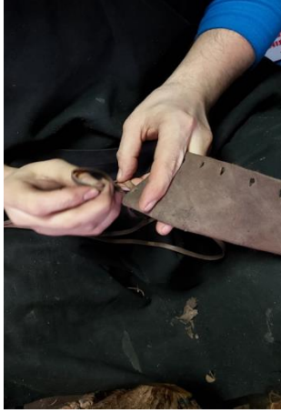
Resim9: Ayna kısmındaki 3 sıra örgü ile örölmeye başlanır.
