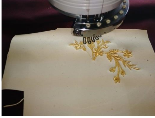
Şekil:38 Sargı parametreleri kullanılarak dijital ortamda tasarlanan Maraş (Dival)ışı tekniğinin kaba- rık durması için işlemenin altına konulan evanın üzerine bilgisayar destekli nakış makinesinde yapılan işlemenin görüntüsü.
