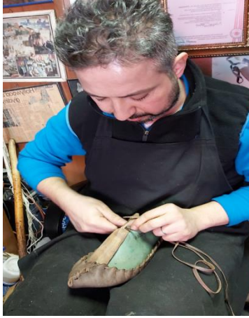
Resim12: Deri şerit arka kısım ve cücükten geçirilerek birbirine örülüyor.
