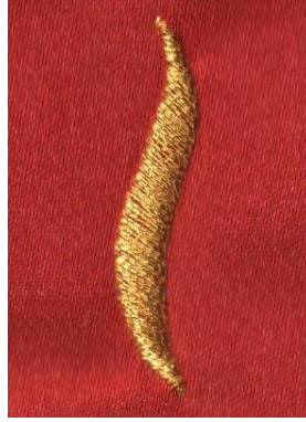
Şekil:10 Sargı parametreleri kullanılarak dijital ortamda tasarlanan vevv sarma tekniğinin bilgisayar destekli işleme makinesinde işlenmiş görüntüsü.
