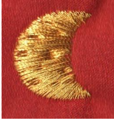
Şekil:24 Sargı parametreleri kullanılarak dijital ortamda tasarlanan delikli sarma tekniğinin bilgisayar destekli işleme makinesinde işlenmiş görüntüsü.
