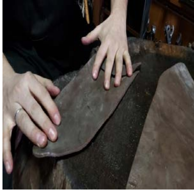
Resim4: Daha sonra 3 saatlik bir suda bekletme süreciyle deriler yumuşatılıyor.
