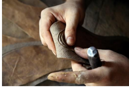
Fotoğraf No:4 Dikiş Kanalının Hazırlanması
