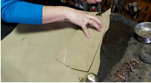
Resim3: Deri parçaları kalıplar kullanılarak belirli bir ölçü ve yapıda kesilir.
