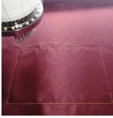
Şekil:35 Sargı parametreleri kullanılarak dijital ortamda tasarlanan Maraş (Dival) işi tekniğinin işleneceği kumaşın bilgisayar destekli nakış makinesinde kumaşın telaya sabitlemesi için atılan tutturma dikişlerin görüntüsü.
