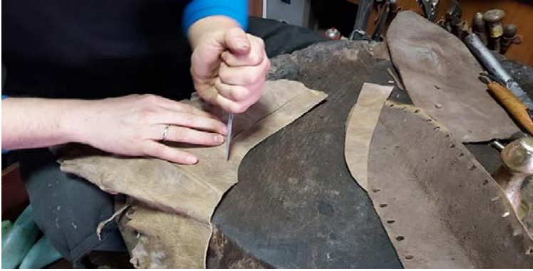
Resim7: Örgü derilerinin bağlanacağı ve ayna kısmını kapatacak deri parçaları kesiliyor
