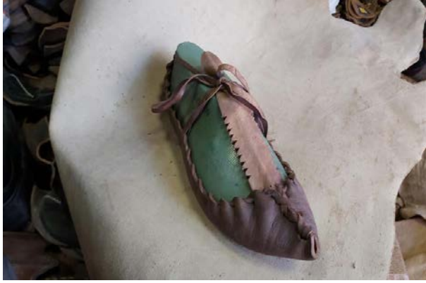
Resim15: Örgülü Çarık (Ham Çarığın) kalıpta bitmiş hali 3 gün bekletilerek derinin kalıba alışarak şekil alması sağlanıyor.
