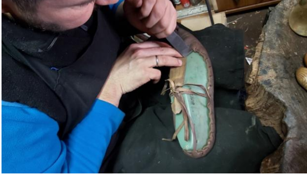
Resim14: Usta cüçük kenarlarını zikzakla yoruyor.
