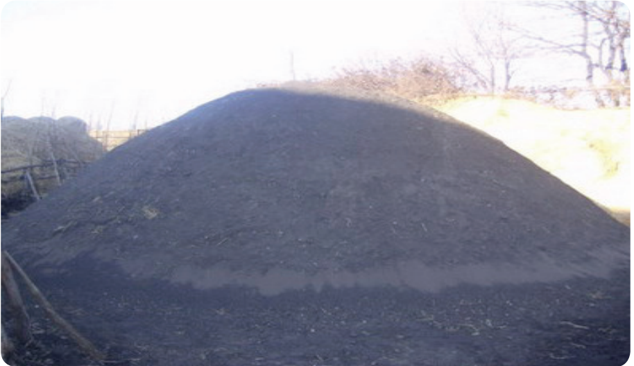
Kömür Elde Edebilmek İçin Odunla Yapılmış Olan Kubbenin Topraklanmış Hali
