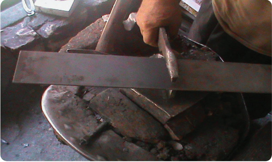
Bıçaklık Demirin Kesilmesi
