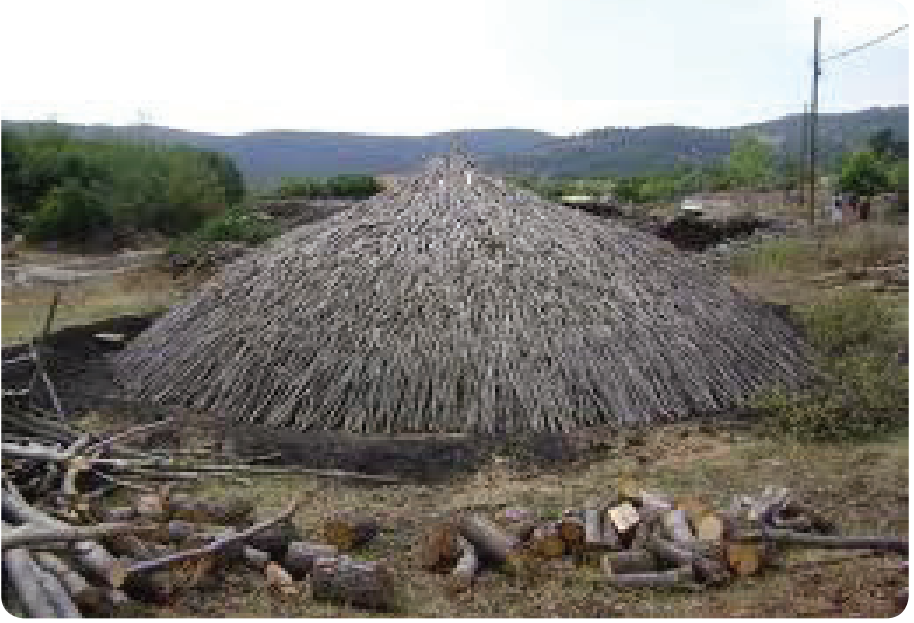
Kömür Elde Edebilmek İçin Odunla Yapılmış Olan Kubbenin Topraklanmadan Önceki Hali
