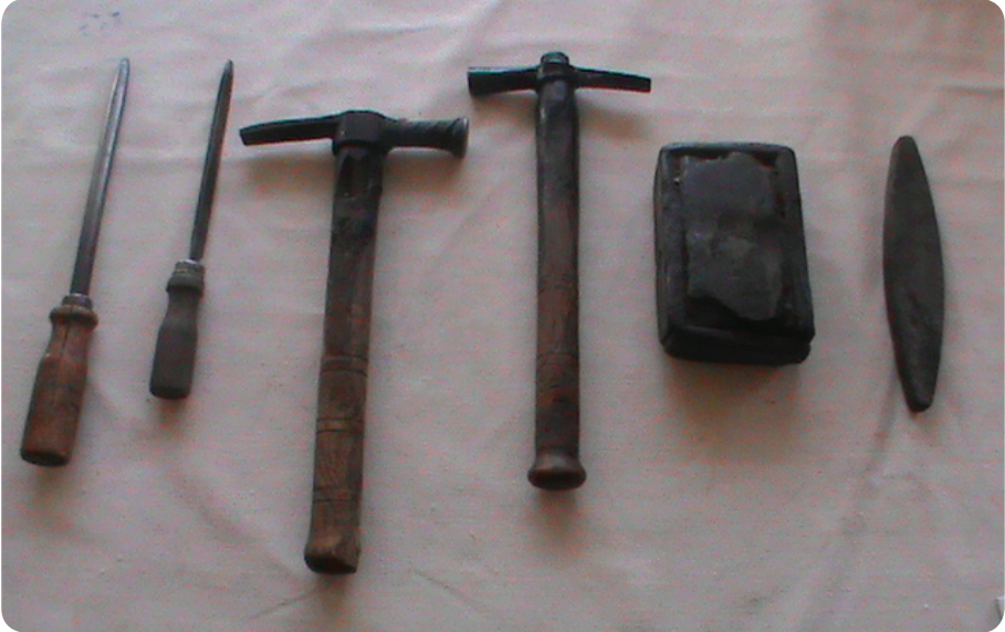
Soldan Sağa: Masat, İye, Büyük Çekiç, Küçük Çekiç, Tabii Bileme Taşı, Suni Bileme Taşı
