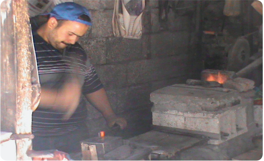
Usta Ökkeş Biber Tarafından Bıçak Namtısının Şekillendirilmesi
