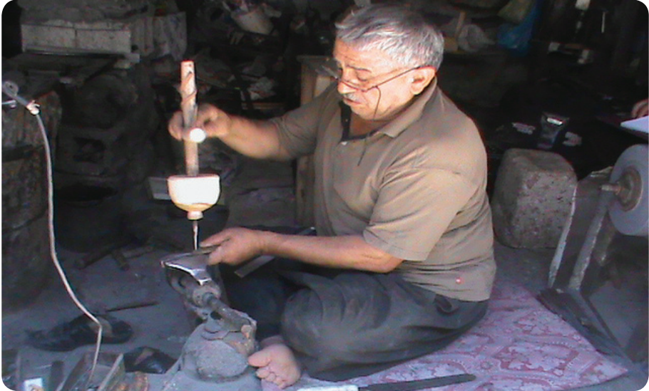
Usta Ejder Biber Tarafından Üdürgü ile Boynuza Delik Açılma İşleminin Yapılması
