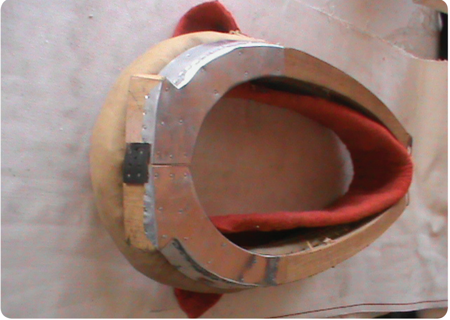
Yapım Aşamasında Hamut İskeleti
